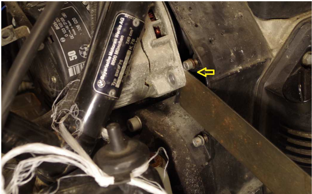
Foto 4: plat voorwerp (winkelhaak) tussen de tussenflens en de dynamo (1 e bout is los).
